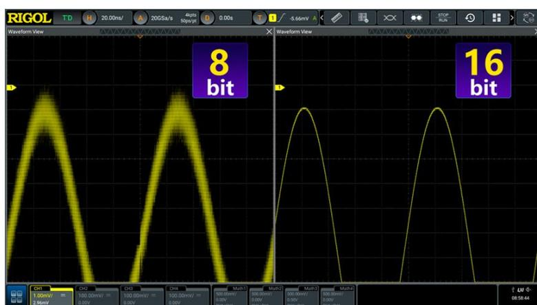
从上图中可以看到，选择 8bit 分辨率时，受 256 个量化等级限制及宽带热噪声的影响，波形线条比较粗且有可见的量化台阶，难以观察信号的细节；而选择 16bit 高分辨率模式时，波形平滑并且细节完美呈现。
