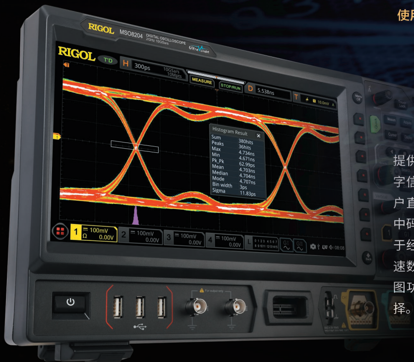
对622 Mb/s 信号进行实时眼图测量
