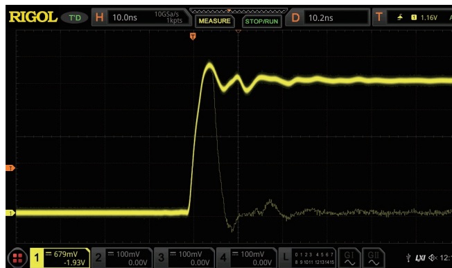
高刷新率模式下捕获偶发异常信号
